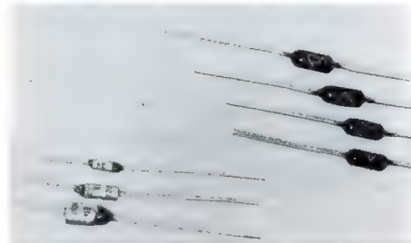
Bild 5. Links: Tantal-Elektrolytkondensatoren von Roederstein, der mittlere hat 120 \mu F Kapazität für 3 V Arbeitsspannung. Rechts: Widerstände der Güteklasse 0,5. Man beachte in beiden Fällen die geringen Abmessungen im Vergleich zu dem untergelegten Millimeterpapier
