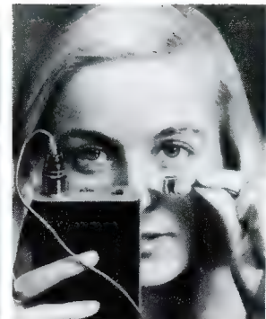
Bild 4. Dynamisches Knopflochmikrofon von Sennheiser für den Reportagesender Mikroport
