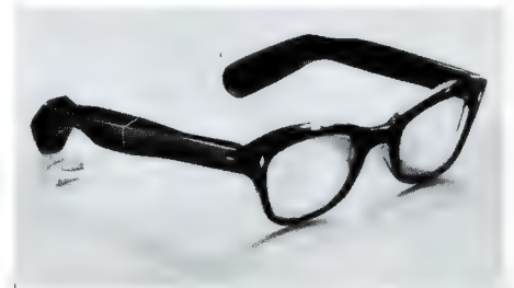
Bild 10 Der gesamte Verstärker in der Omnitron-Hörbrille HB 2 ist in dem keulenförmigen Ansatz links untergebracht; die Trennfuge wurde zur Deutlichmachung übertrieben dargestellt
